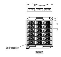
根据型号,未使用的端子部(7-12号)端子台将不会安装
