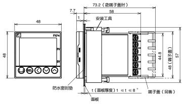
\*使用面板安装状态的装载机时: t(面板厚度)1 ≤t≤4
